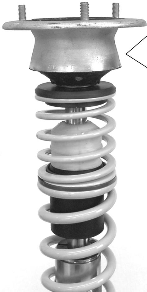
Serienstützlager aufsetzen und mit der mitgelieferten Stoppmutter verschrauben. Anzugsdrehmoment 50 Nm. Die Montagehinweise zum Einbau des Federbeines in das Fahrzeug, sowie die Anzugsdrehmomente der Federbeinbefestigung, entnehmen Sie bitte den Unterlagen des Fahrzeugherrstellers.
